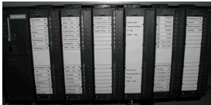
Rechts: Klassischer Schaltschrank mit SPS (SIEMENS S7-300) während der Verdrahtung.
